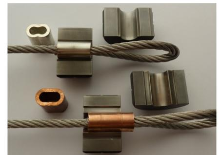
Bei verkürzter Pressbreite können auch größere Klemmen verpresst werden (Crimp- oder Mehrfach-Pressung). Siehe dazu auch die Bedienungsanleitung "Hydraulischer Presskopf H30 + Presseinsätze P58". Für ovale Seilklemmen aus Kupfer sind die Presskräfte ca. 50% höher als für Aluminium.
